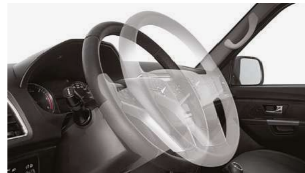
В UAZ Pickup регулировка рулевого колеса осуществляется как по углу наклона, так и по вылету
